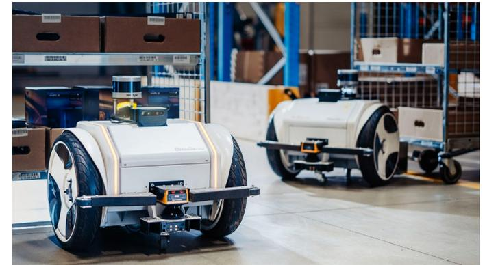
An unserem Standort in Greven-Reckenfeld unterstützen zwei Autonome Mobile Roboter bei der Einlagerung von Kleinteilen.
